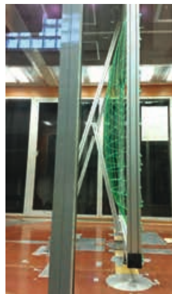
Instalace pokusu na měření zatížení větrem
